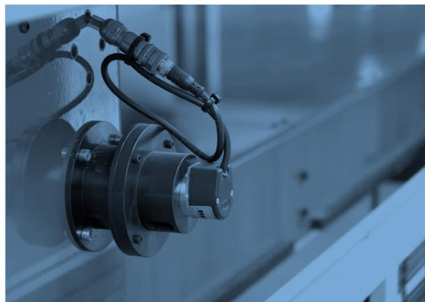
Encoder di misura della traversa intermedia che garantisce il posizionamento centrato dei piani intermedi, con programmazione dell'altezza di lavoro da touch screen del quadro comandi o tramite sistema informatico gestionale.
