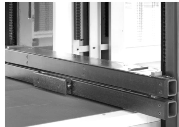
Centratore pneumatico per il corretto allineamento del mobile prima della chiusura finale. Doppio programma di chiusura adatto per pannelli verniciati e laccati lucidi, per evitare danneggiamenti alle superfici.
