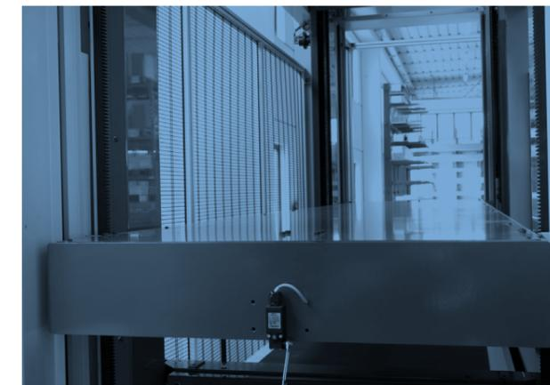
Pressore superiore guidato nella discesa da 8 cremagliere poste sui montanti macchina per una corretta e planare discesa con omogenea distribuzione del carico.
